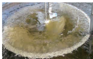
垂直扰动系统 形成水体的垂直循环, 阻止水体分层, 增加水容氧量, 加速污染物分解。
